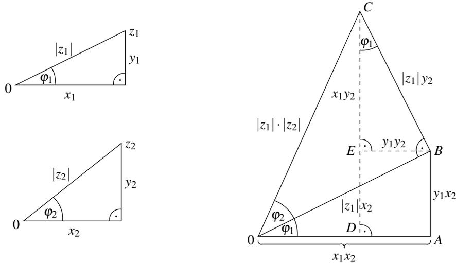
Aus diesem Bild lesen wir nun direkt ab, dass  $C$  die Koordinaten  $(x_1x_2 - y_1y_2, x_1y_2 + y_1x_2)$  hat, also genau der Punkt  $z_1 \cdot z_2$  ist. Da dieser Punkt den Betrag  $|z_1| \cdot |z_2|$  hat und den Winkel  $\varphi_1 + \varphi_2$  mit der positiven reellen Achse einschließt, sehen wir anschaulich:
